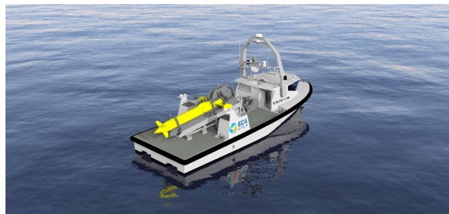
De 12 m. lange INSPECTOR-125 USV met drones
